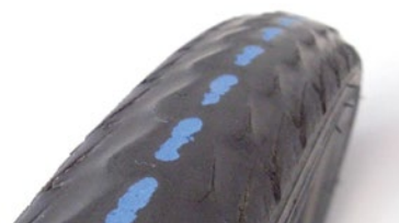
Der Pannenschutz scheint durch. Der Reifen muss dringend gewechselt werden.
